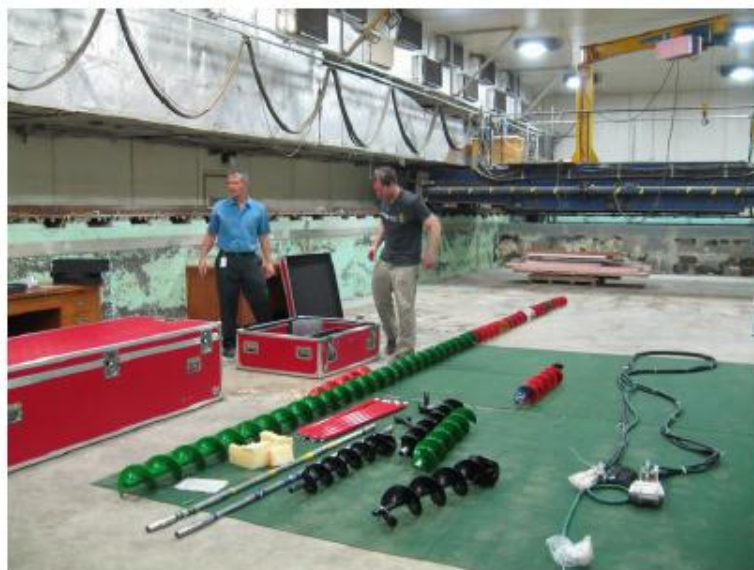
Figure 6. Une partie de l'équipement nécessaire pour le programme sur le terrain. Le châssis de forage est dans la grosse boîte rouge. La tarière verte et rouge indique jusqu'à quelle profondeur la glace sera forée (12 m) et analysée avec le pénétrateur de trou de forage (à droite).
